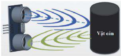
Hình 3.5. Nguyên lý hoạt động của cảm biến siêu âm
