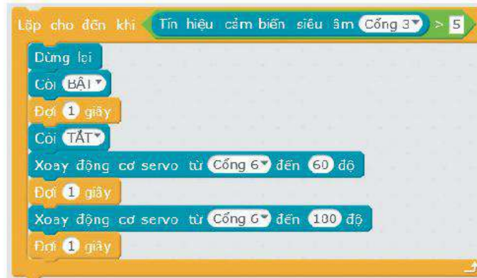
Hình 14.9. Chương trình điều khiển động cơ servo gạt vật cản ra khỏi sa bàn
