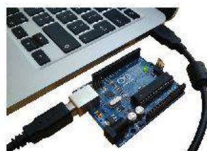
b) Cấp nguồn cho bảng mạch điều khiển qua cổng USB
