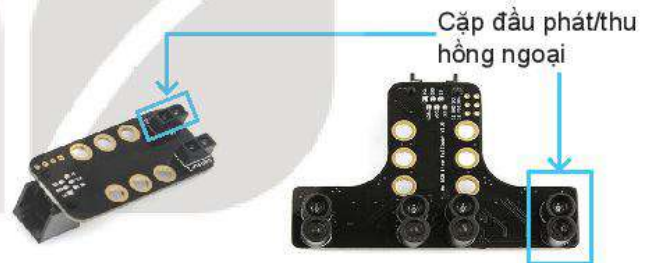
Hình 3.3. Cảm biến dò đường hai mắt và bốn mắt
