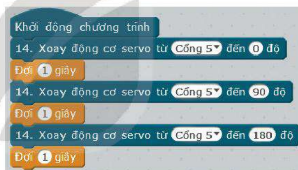
Hình 8.7. Chương trình kiểm tra động cơ servo
