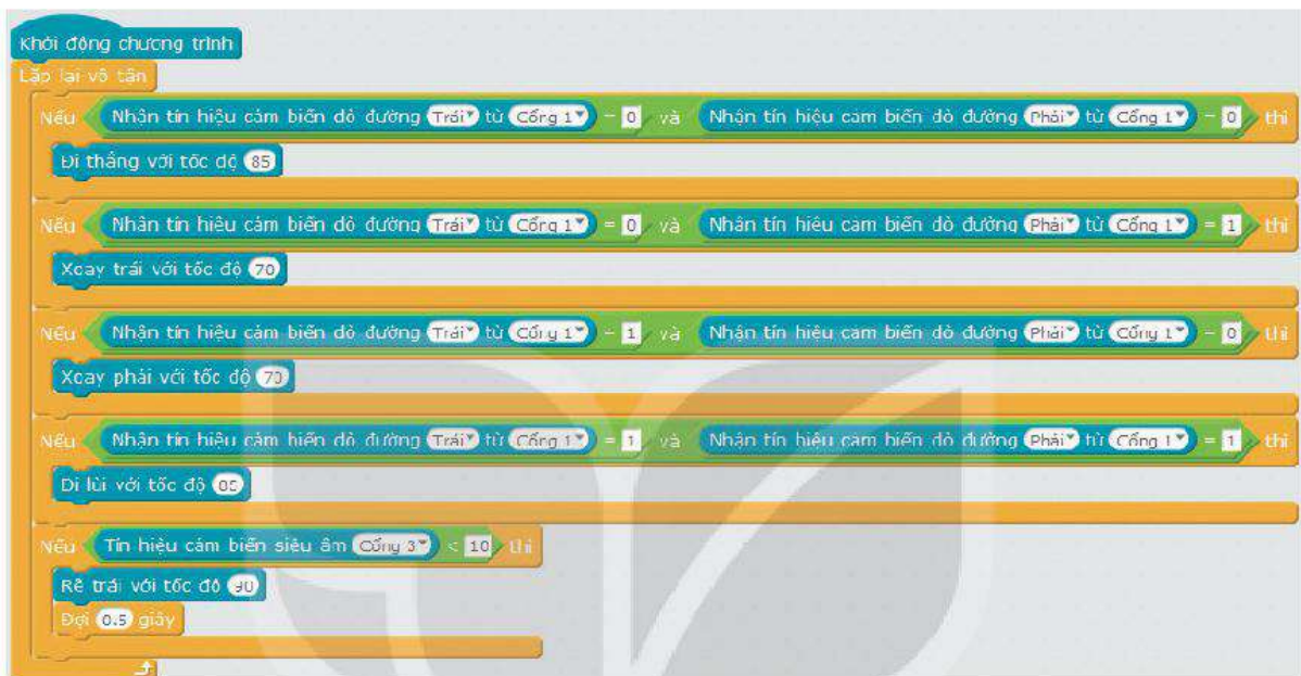
Hình 12.9. Chương trình hoàn thiện để robot thực hiện nhiệm vụ 2
