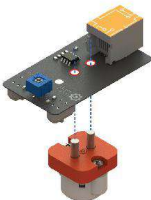
Hình 4.11. Lắp ghép cảm biến dò đường vào bánh xe đa hướng
