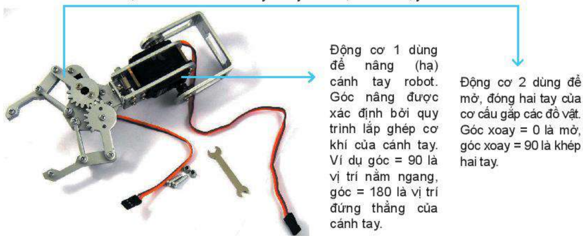
Hình 9.5. Mô hình cánh tay máy hai bậc
